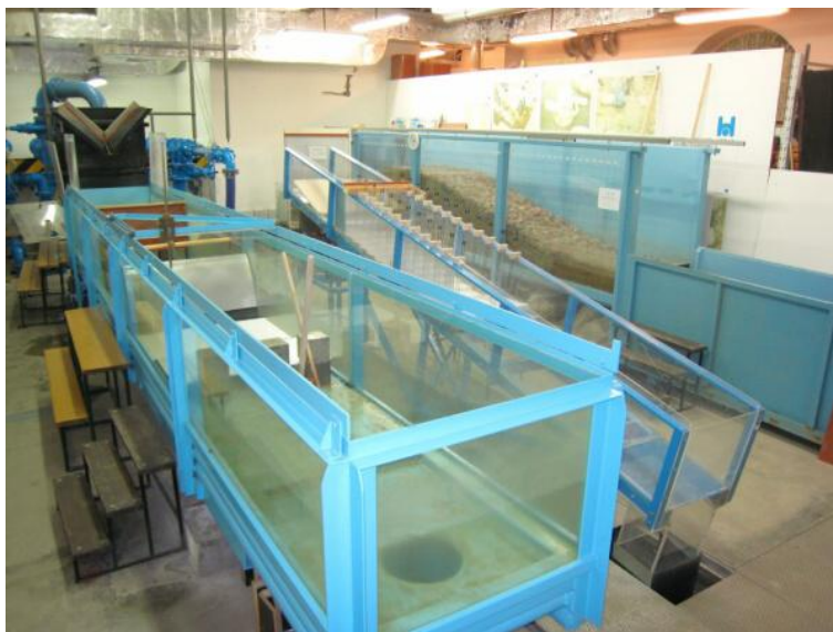
Obr. 5 Pohled na tři měrné žlaby hydraulického okruhu č.2
