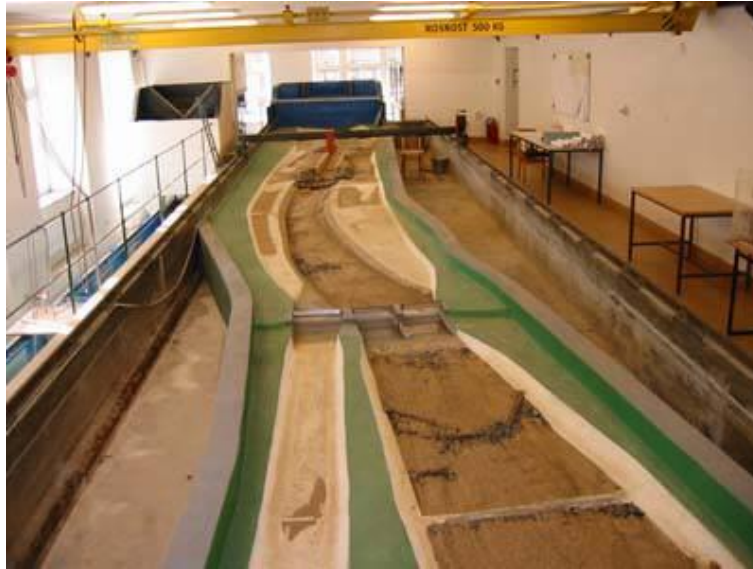
Obr. 1 Protiproudňý pohled na model koryta vodňího toku ve žlabu šířky 3,5 m, vlevo nátok do žlabu šířky 1,0 m
