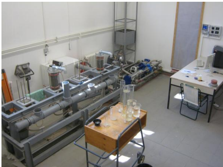
Obr. 9 Vlevo pohled na hydraulický okruh, lavice s testovacími válci, v rohu polohovatelná gravitační nádrž, vpravo pohled na čerpadla Vogel s regulačními jednotkami HYDROVAR
