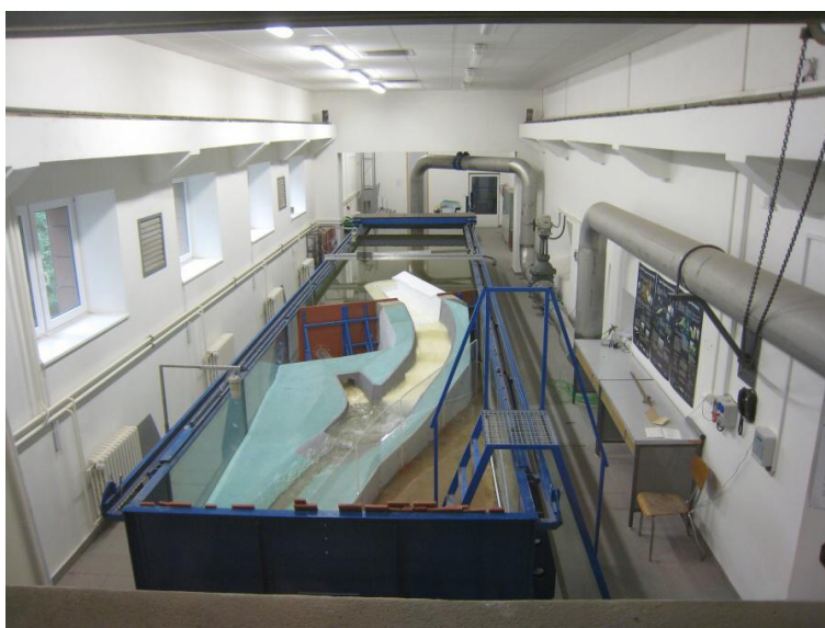
Obr. 8 Pohled do jedné z hal budovy F na měrný žlab šířky 2,5 m s modelem bezpečnostního objektu
