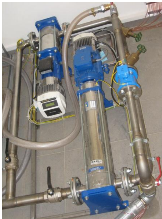
Obr. 9 Vlevo pohled na hydraulický okruh, lavice s testovacími válci, v rohu polohovatelná gravitační nádrž, vpravo pohled na čerpadla Vogel s regulačními jednotkami HYDROVAR
