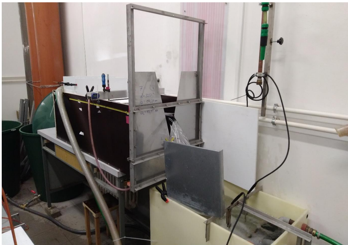
Obr. 1. Měřicí trať s tenkostěnným trojúhelníkovým přelivem.
