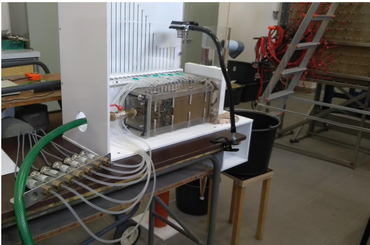
Obr. 4. Experimentální zařízení pro výzkum vývoje privilegované průsakové cesty
