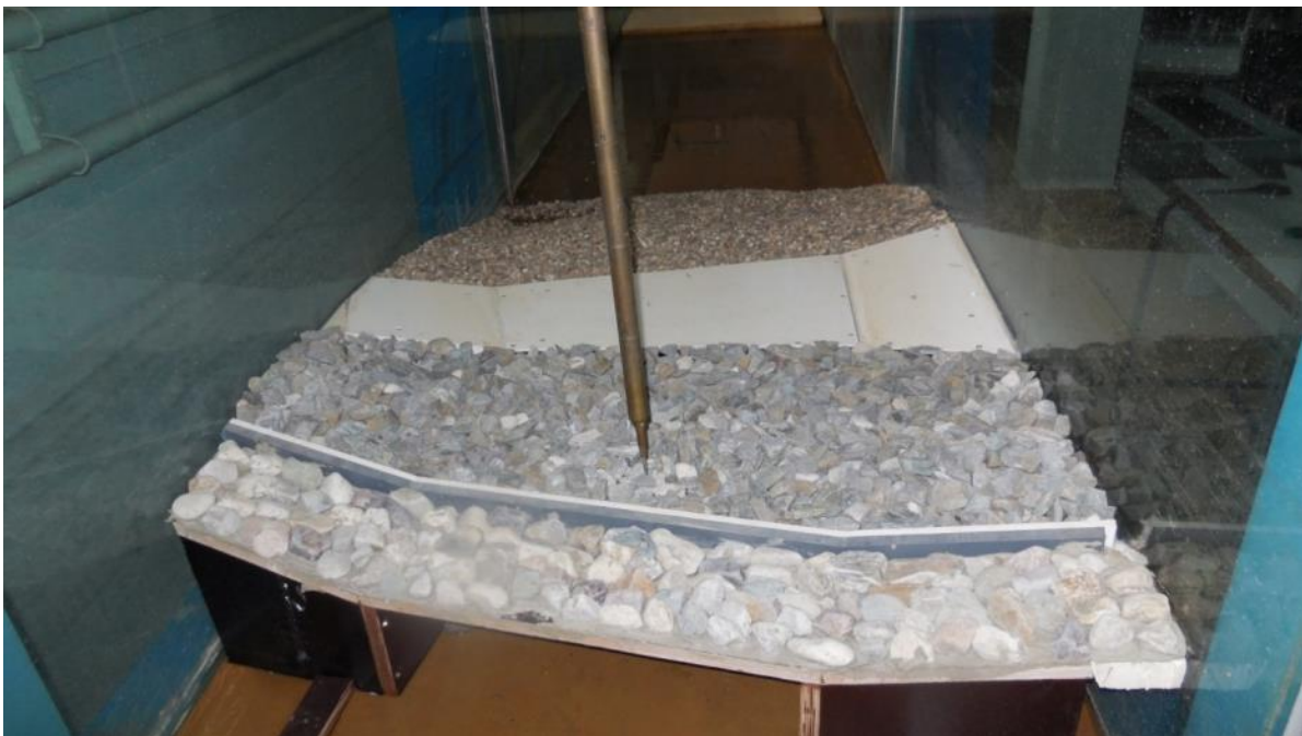
Nouzový přeliv – fyzikální model
