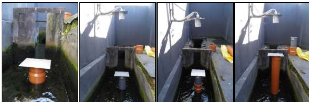
Obrázek 5 Způsob simulace úrovně hladin na odtoku ČOV Bučovice
