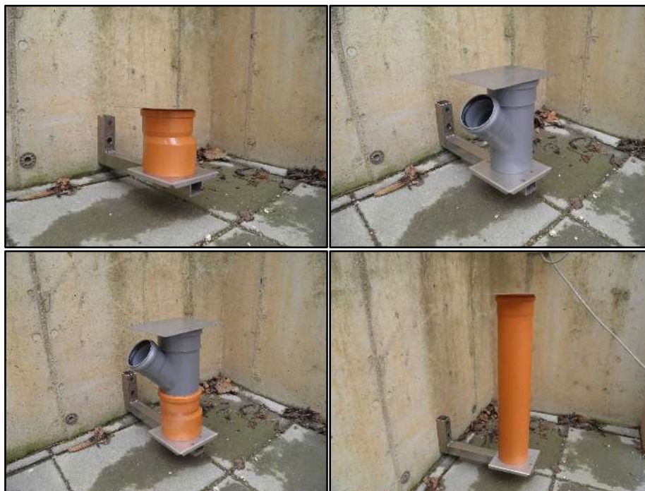
Obrázek 4 Způsob simulace úrovně hladin v laboratoři F
