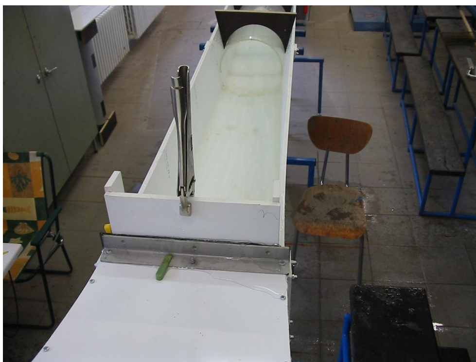
Foto 2. Zkoušky tlumení kinetické energie proudu pomocí vložené uklidňovací nádrže s hradítkem
