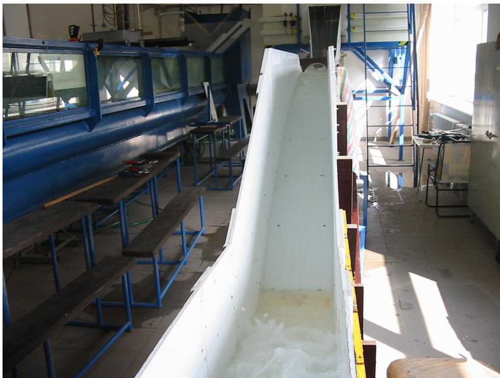
Foto 9. Poloha začátku vodního skoku na zvýšeném dně vývaru při Q = 45 \text{ m}^3 \cdot \text{s}^{-1} a hloubce vody v korytě H = 3,54 \text{ m} (scénář N61)
