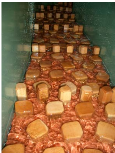
Projektantem navržené zdrsňující prvky v rybím přechodu
