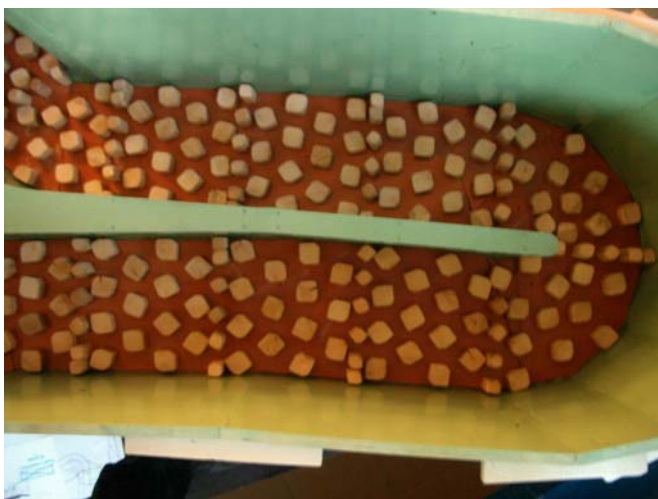
Projektantem navržené zdrsňující prvky v rybím přechodu
