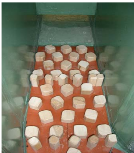
Projektantem navržené zdrsňující prvky v rybím přechodu
