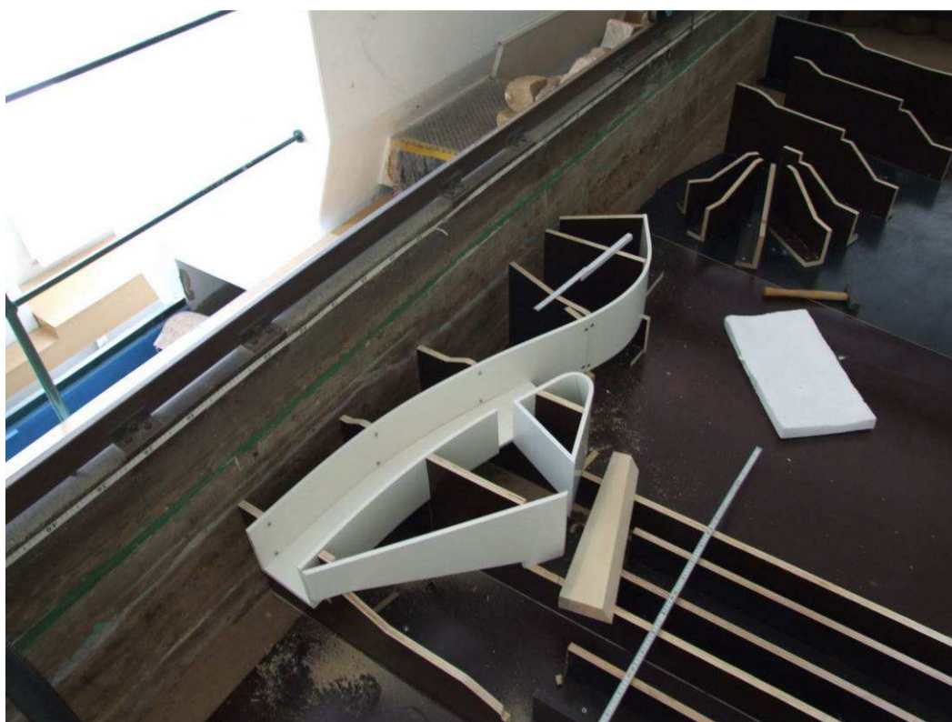
Obr. 2 Výstavba modelu – nátok do náhonu na MVE
