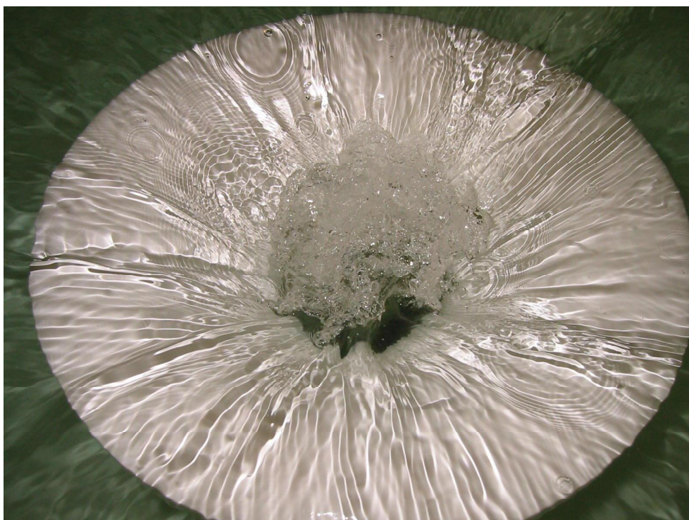
Foto 4. Vyvzdušnění prostoru šachty nálevkou s propagací tlakových pulzací do odpadní štolý ( Q_{skut} = 115 \text{ m}^3 \cdot \text{s}^{-1} )
