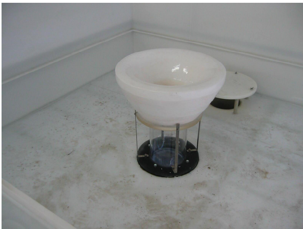
Foto 2. Umístění modelu nálevky šachtového přelivu v prostoru nádrže
