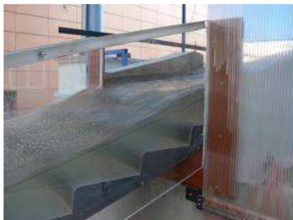
Obr. 20. Pohled na koncový profil spadišřě a navázání stupňovitěho skluzu, var 1,
