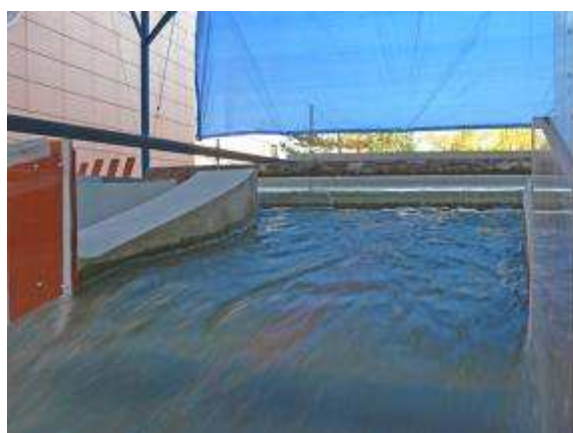
Obr. 19. Protiproudňí pohled do spadišřě a vliv kontrakcí v mřřě zůženří na tvar hladiny, var 1, Q_{10\ 000} = 310,50 \text{ m}^3 \cdot \text{s}^{-1} .
