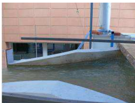
Obr. 19. Protiproudňí pohled do spadišřě a vliv kontrakcí v mřřě zůženří na tvar hladiny, var 1, Q_{10\ 000} = 310,50 \text{ m}^3 \cdot \text{s}^{-1} .
