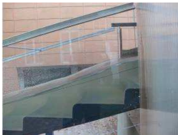
Obr. 20. Pohled na koncový profil spadišřě a navázání stupňovitěho skluzu, var 1,
