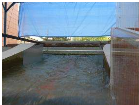
Obr. 18. Protiproudňí pohled do spadišřě a vliv kontrakcí v mřřě zůženří na tvar hladiny, var 2, Q_N = 284,51 \text{ m}^3 \cdot \text{s}^{-1} .
