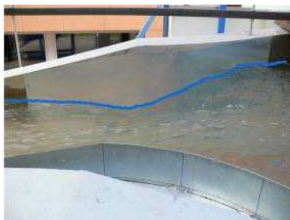
Obr. 18. Protiproudňí pohled do spadišřě a vliv kontrakcí v mřřě zůženří na tvar hladiny, var 2, Q_N = 284,51 \text{ m}^3 \cdot \text{s}^{-1} .
