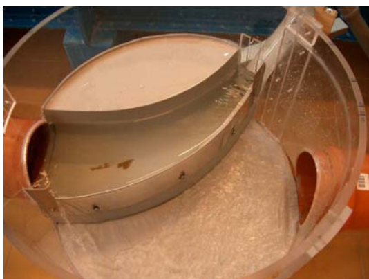
Obr. 10 Q_p = 2,5 \text{ l/s} ; Škrčení na ČOV - otevřeno
