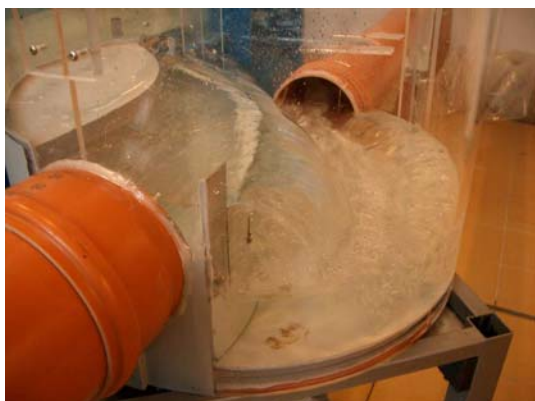
Obr. 16 Q_p = 11 \text{ l/s} ; Škrčení na ČOV – otevřeno
