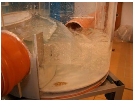
Obr. 17 Q_p = 11 \text{ l/s} ; Škrčení na ČOV – škrčení
