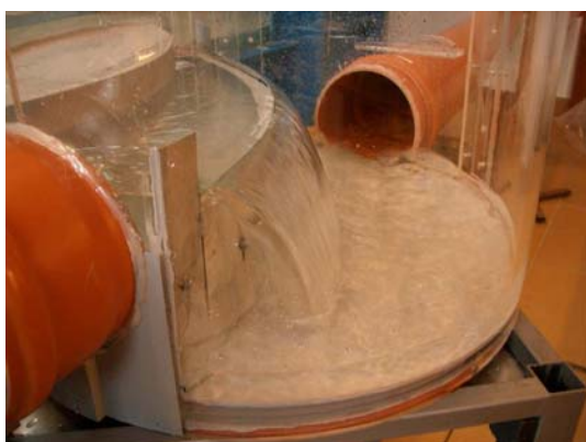
Obr. 14 Q_p = 4,4 \text{ l/s} ; Škrčení na ČOV – škrčení
