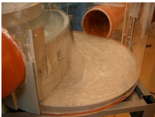
Obr. 13 Q_p = 4,4 \text{ l/s} ; Škrtení na ČOV – otevřeno
