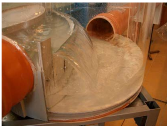
Obr. 15 Q_p = 4,4 \text{ l/s} ; Škrčení na ČOV – zavřeno
