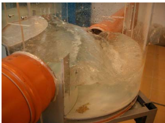
Obr. 18 Q_p = 11 \text{ l/s} ; Škrčení na ČOV – zavřeno
