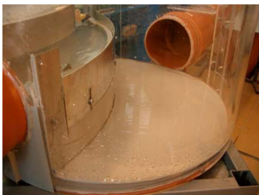
Obr. 10 Q_p = 2,5 \text{ l/s} ; Škrčení na ČOV - otevřeno
