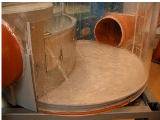
Obr. 11 Q_p = 2,5 \text{ l/s} ; Škrčení na ČOV – škrčení
