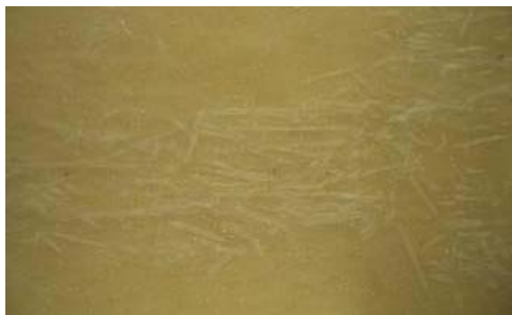
Vnitřní povrch vzorku B po 1350 hodinách zatěžování
