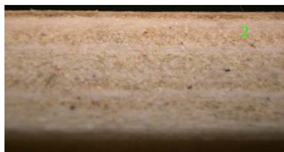
Skladba stěny zkoušených trubek v příčném řezu
