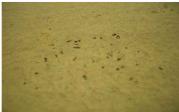
Vnitřní povrch vzorku A po 1350 hodinách zatěžování
