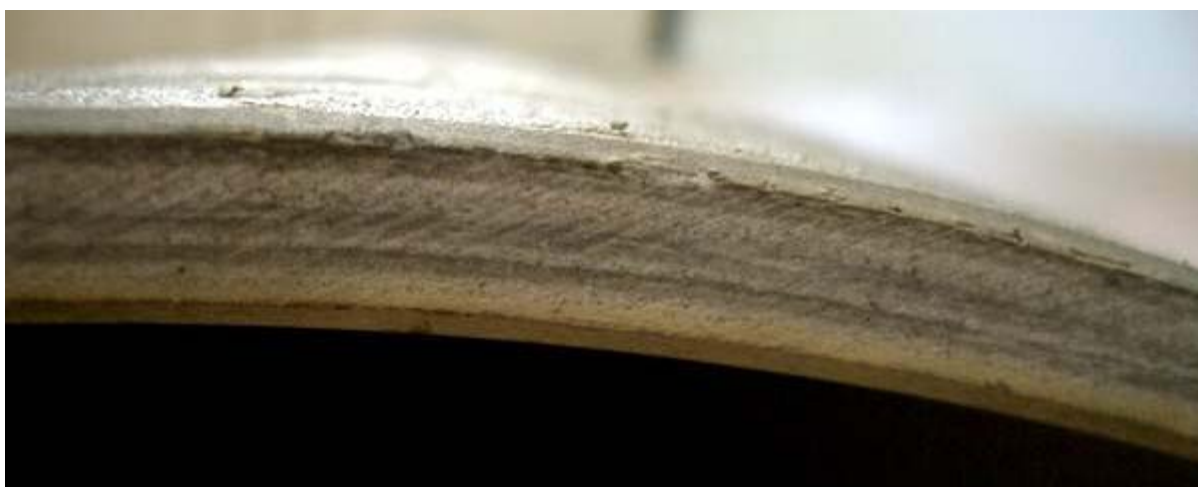
Skladba stěny vzorku A v příčném řezu
