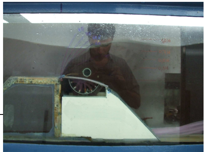
obr. 10,11 – schéma s rozměry instalovaného podjezí a průběh h_d = 1,0H při \alpha = 0^\circ
