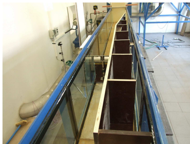
obr.4,5 – pohled na instalaci modelu M 1:1 v pohyblivém žlabu o šířce 412 mm
