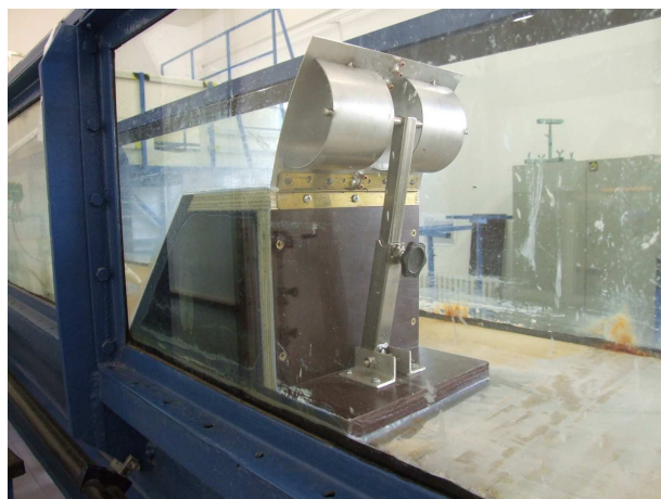
obr.4,5 – pohled na instalaci modelu M 1:1 v pohyblivém žlabu o šířce 412 mm
