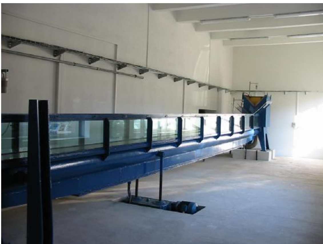
Obr 5. Pohled na žlab 40 - konečné řešení, vedle prostor pro další měrnou trať
