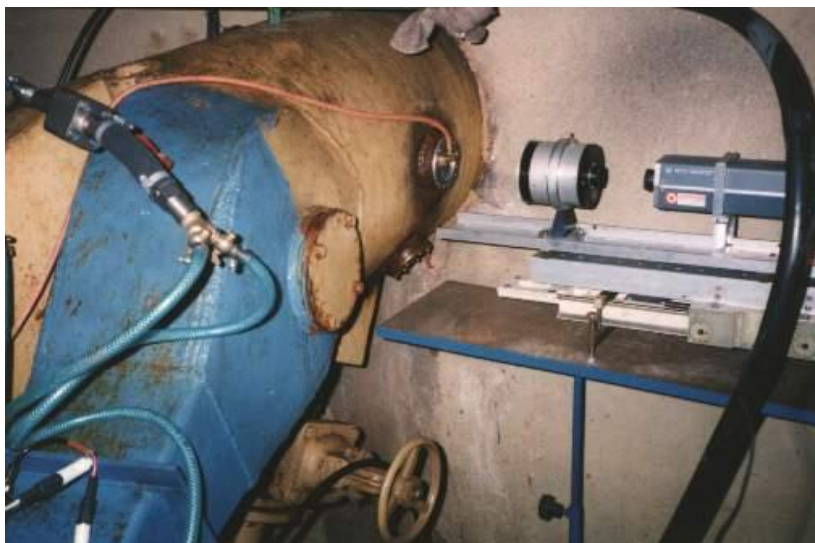
Obr. 15 Měření průtoku v tlakovém přiváděči MVE laserovým dopplerovským anemometrem pro stanovení účinnosti turbíny na díle
