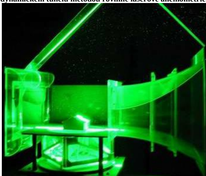
Obr. 25 Měření struktury proudění při dynamickém modelu budovy v aerodynamickém tunelu metodou rovinné laserové anemometrie
