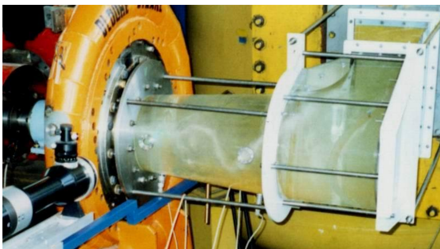
Obr. 14 Měření časového vývoje rychlostního pole s vírovým „copem“ na výstupu z oběžného kola Francisovy turbíny laserovým dopplerovským anemometrem
