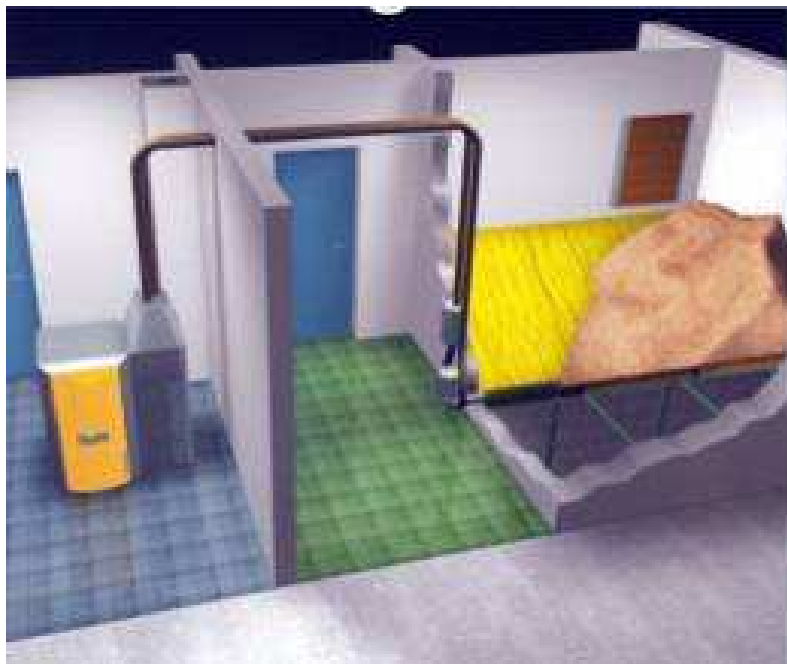
Kotel na pelety, sklad pelet, pneumatický dopravník
