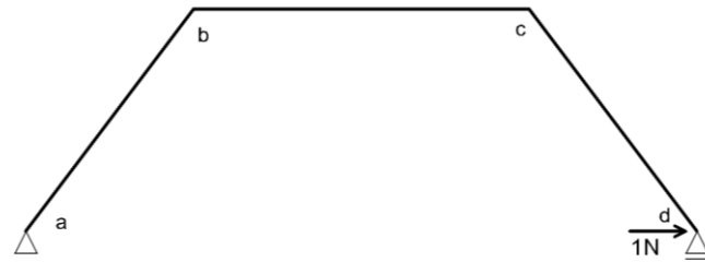
Obr.: Zatěžovací stav 1
