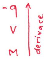
derivaci posouvající síly je intenzita spoj. zatížení
