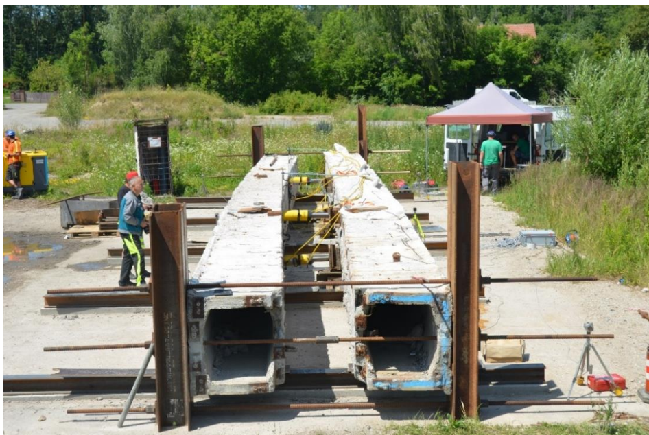
Obr. č. 5.2: In situ prováděná zatěžovací zkouška předpjatých mostních nosníků, demontovaných z existující mostní konstrukce. Cílem zkoušky bylo ověřit zbytkovou únosnost nosníků a jejich chování při zhoršení stavu předpínací výztuže.
