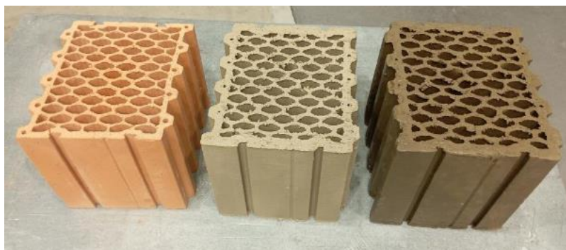
Obr. č. 5.1: Fotografie dematerializované zdicí tvarovky vyvinuté společně s firmou Wienerberger, která je určena pro robotickou výstavbu
