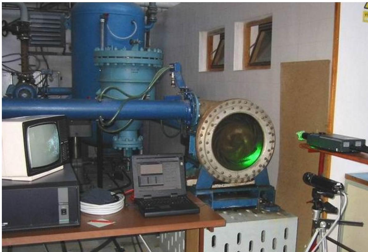
Obr. 1 Měření v rozvaděči rotočerpádlu
