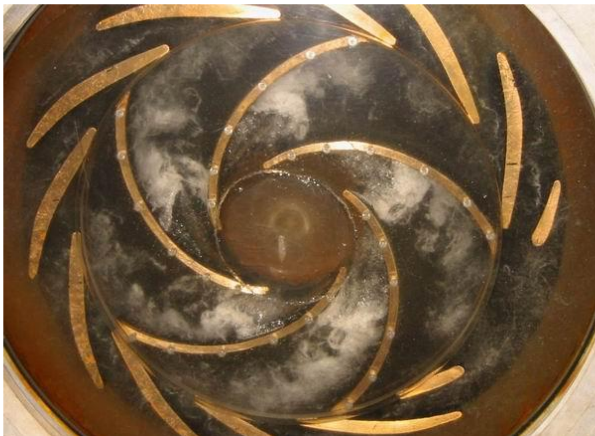
Obr. 3 Kavitační jevy v oběžném kole a rozvaděči rotočerpadla
