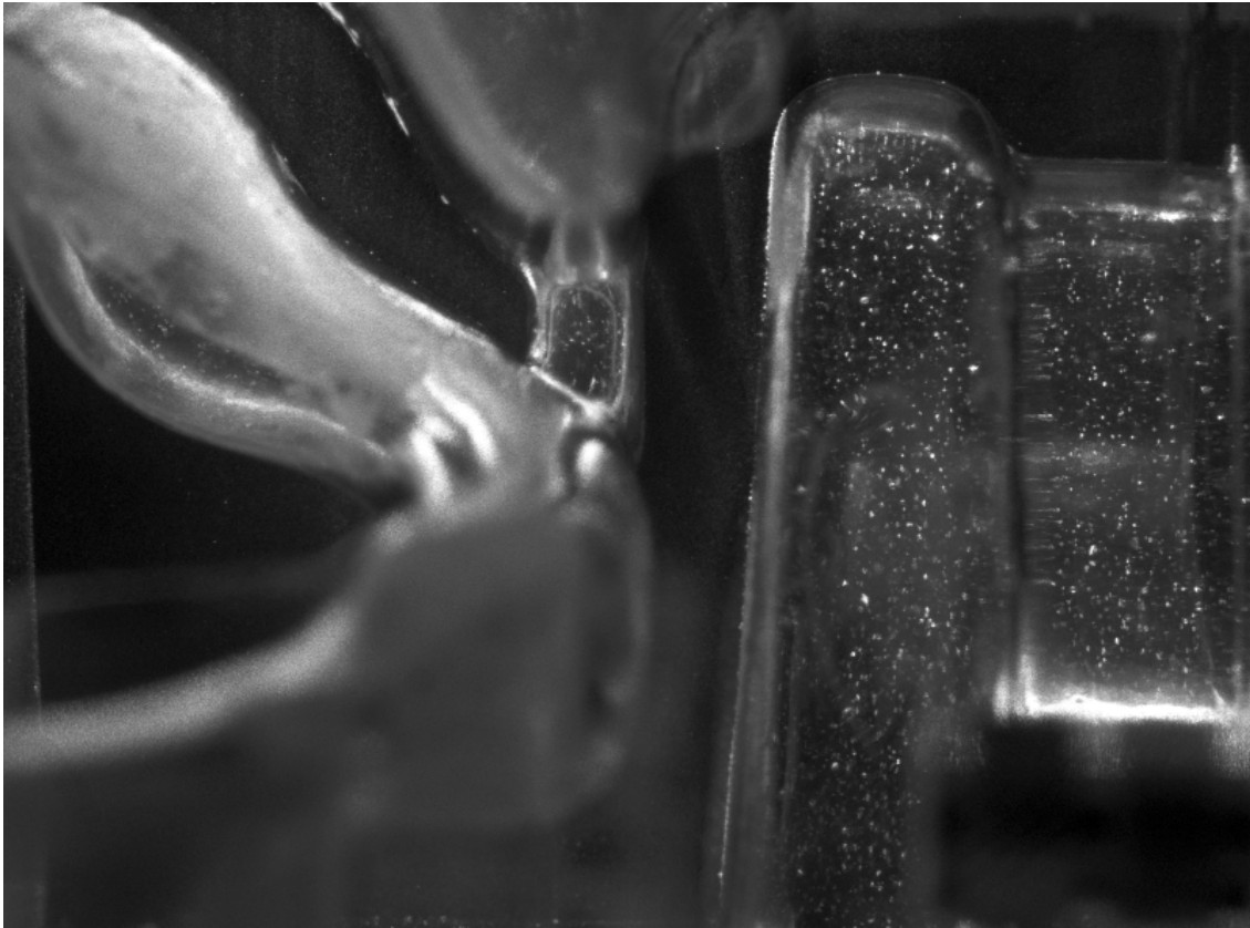
Obr. 6 Obraz unášených částic v detailu modelu, vodní náplň s běžnými částicemi
