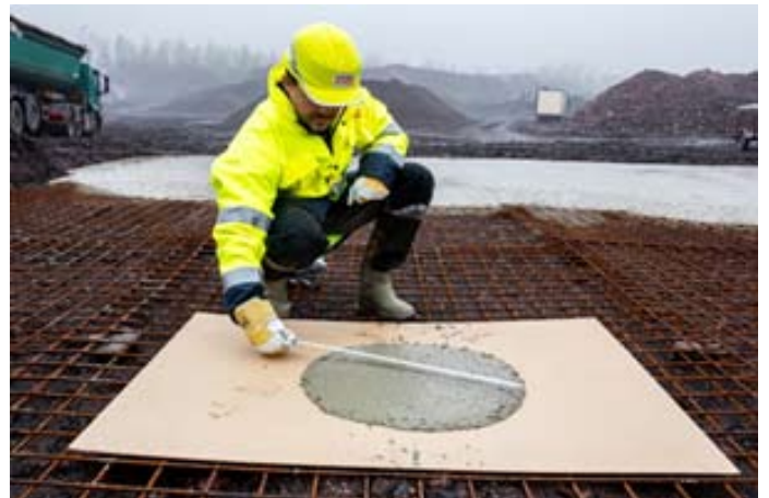
Obr.: 26 a Obr.: 27 Stanovení konzistence sednutí-rozlitím směsi QCC
