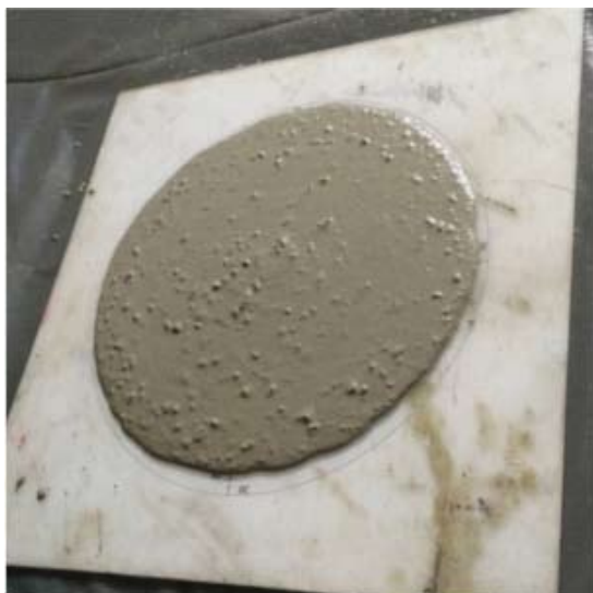
Obr.: 3 Rozlití Haegermannova kužele
