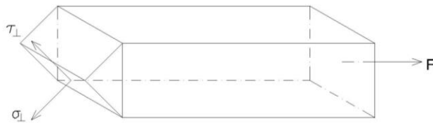
Obr.: Čelní svar – napětí v kritickém řezu
