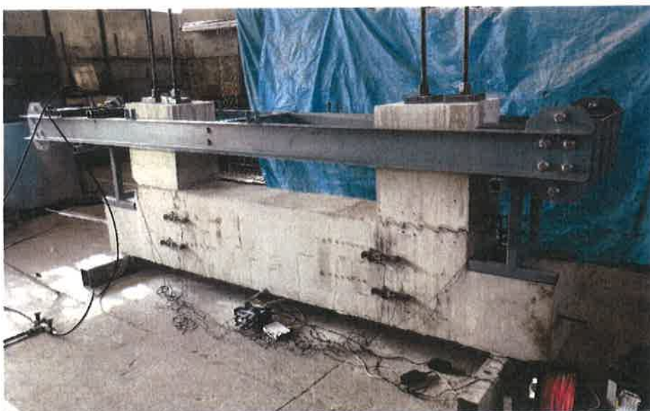
Obr. 1: Pohled na funkční vzorek tvořený rovnovážnou soustavou a lůžkem pro zatěžovací hydraulické lisy; osazená měřicí soustava deformometrů, snímačů posunu a teploty
