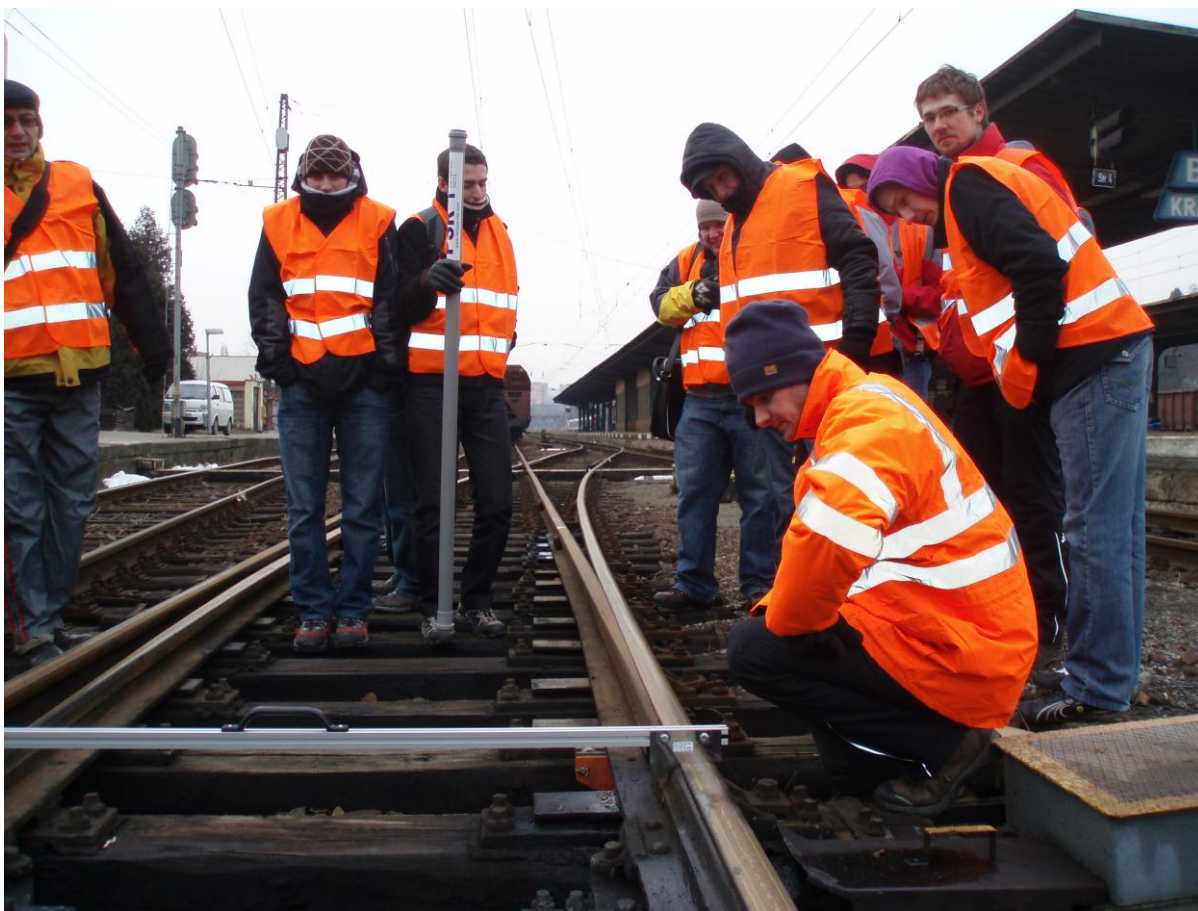
Obrázek 3 – Posouzení možnosti nájezdu kola na hrot jazyka výhybky prostorovou šablonou PŠR-3
