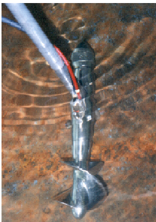
Měření bodových rychlostí vodoměrnou vrtulí
