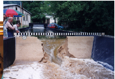
Měření průběhu rozplavení sypané hráze
