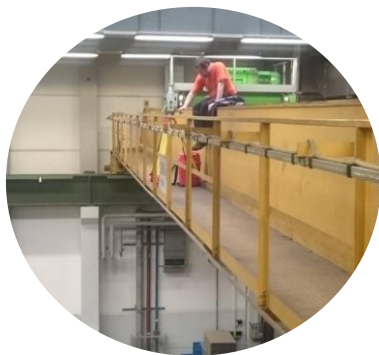
MĚŘENÍ GEOMETRICKÝCH PARAMETRŮ JEŘÁBOVÝCH DRAH
