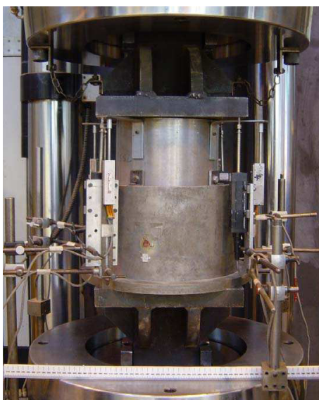
Obrázek 4.2: Fotografie edometrického testu na Nottinghamské univerzitě vyjmutá z LIM, Wee Loon (2004).
