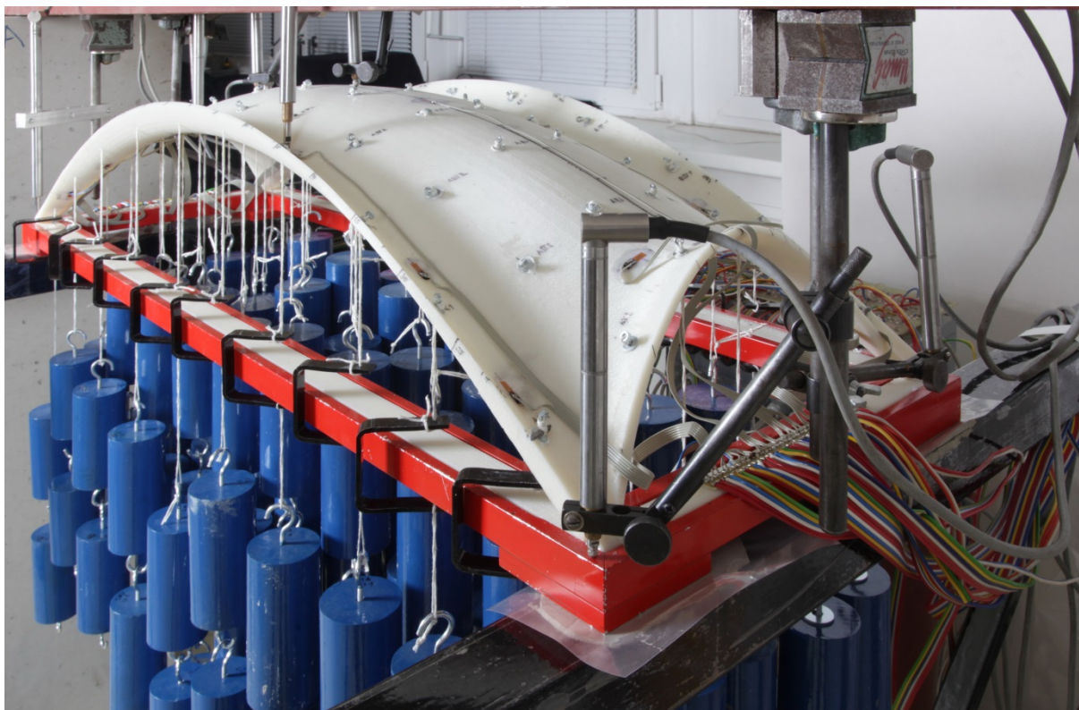
obr. 7 Zkouška modelu skořepiny
