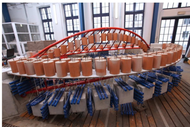
Obrázek 14 – Testování modelu - plné nahodilé zatížení
