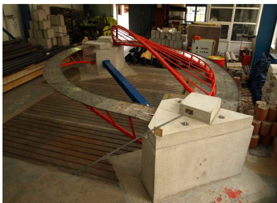
obr. 15 Model před betonáží mostovek
