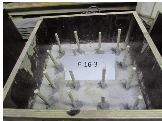
Obr. 5 Zkušební vzorky – 16 trnů (betonářská výztuž - GFRP)
