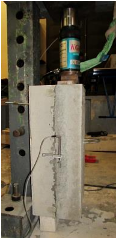
Obr. 3 Zatěžovací sestava pro zkoušky smykové odolnosti spřahovacích trnů
