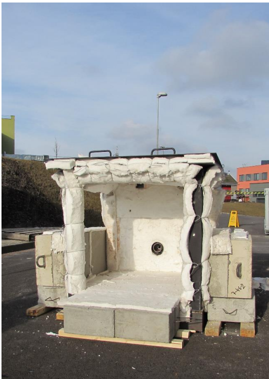
Obr. 25 Příprava experimentu – postupné kladení zkušebních bloků z bočních a zadní strany pece
