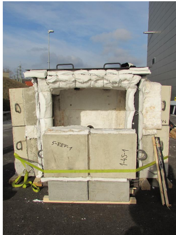
Obr. 25 Příprava experimentu – postupné kladení zkušebních bloků z bočních a zadní strany pece
