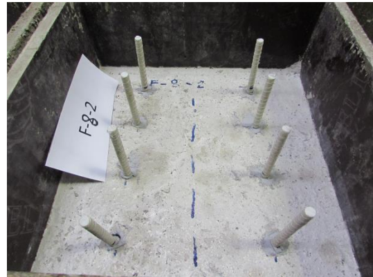
Obr. 6 Zkušební vzorky – 8 trnů (betonářská výztuž - GFRP)
