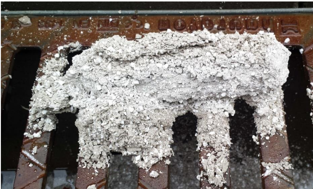
Obr. 72: Zkušební vzorek MA po požární zkoušce a po aplikaci vody
