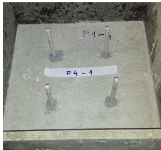
Obr. 7 Zkušební vzorky – 4 trny (betonářská výztuž - GFRP)
