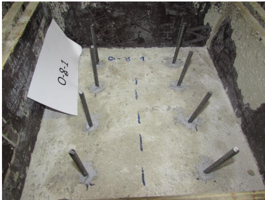
Obr. 6 Zkušební vzorky – 8 trnů (betonářská výztuž - GFRP)
