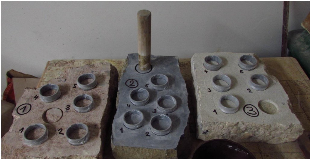
Obr. 59: Příprava vzorků pro zkoušku přídržnosti
