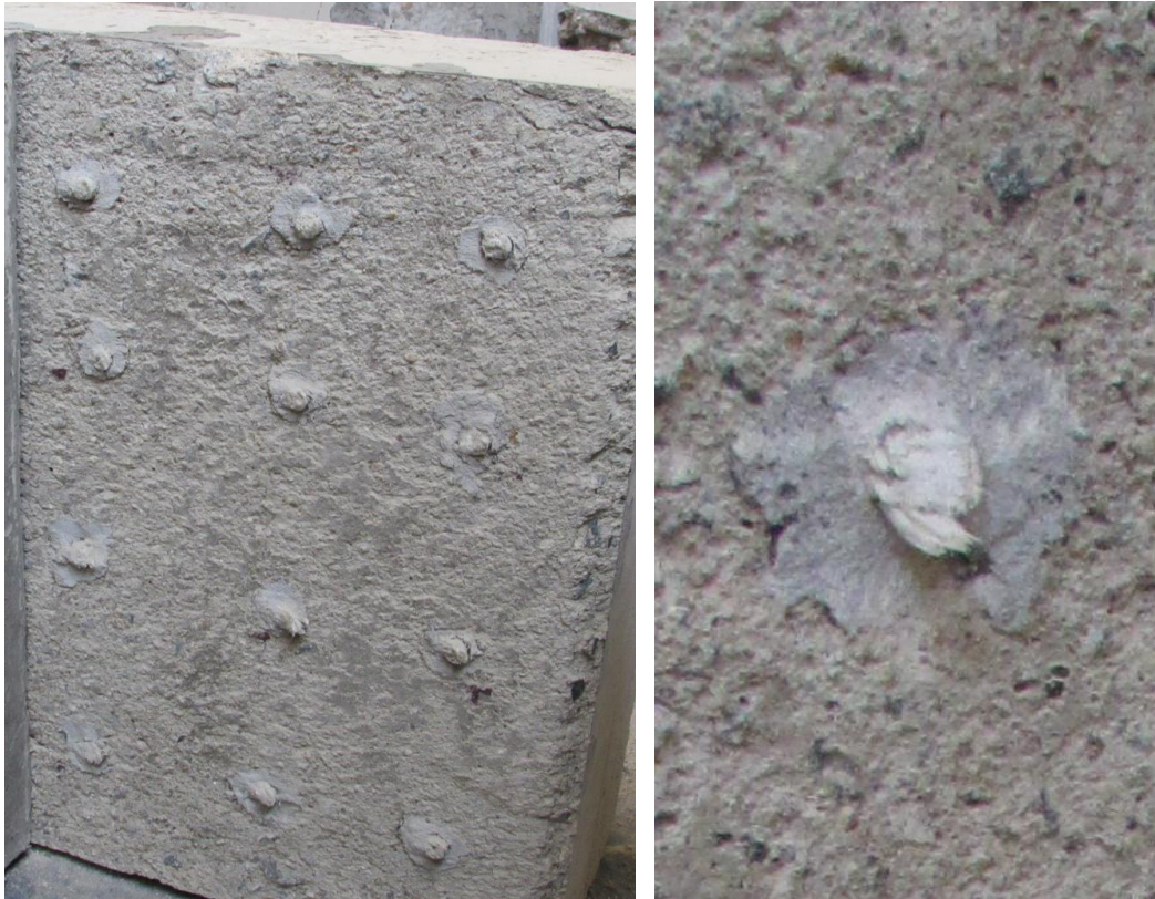
Obr. 20 Porušení GFRP výztuže při dosažení maximální únosnosti – bloky 2. etapy
