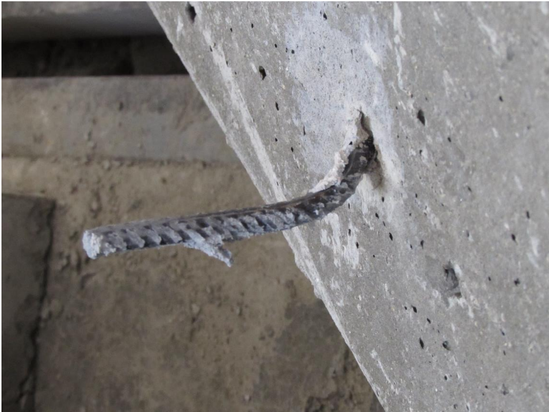
Obr. 22 Deformace betonářské výztuže po dosažení maximální únosnosti sprážení – bloky 2. etapy – nepřetržitý prut po ukončení zkoušky
