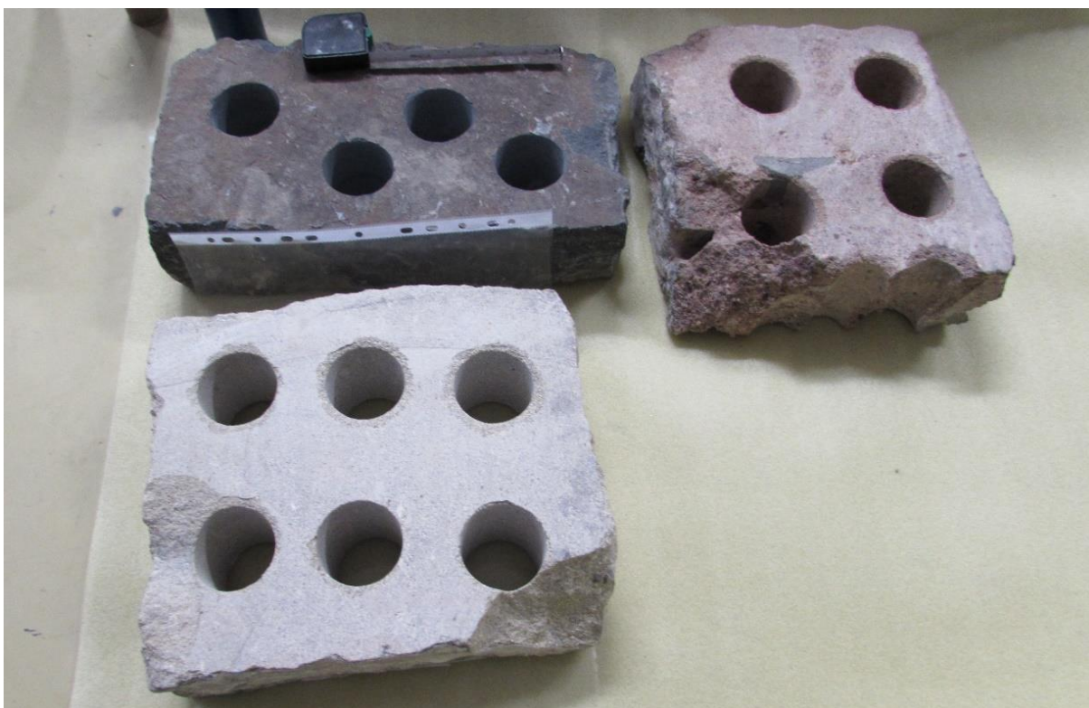
Obr. 61: Tělesa pro zkoušku protlačení spárovací hmoty
