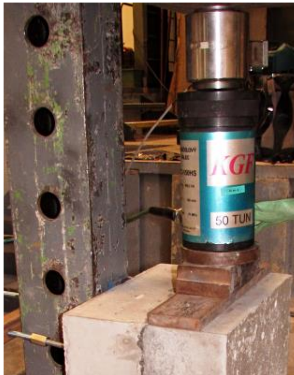
Obr. 3 Zatěžovací sestava pro zkoušky smykové odolnosti spřahovacích trnů
