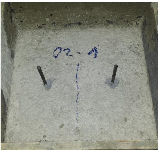
Obr. 8 Zkušební vzorky – 2 trny (betonářská výztuž - GFRP)
