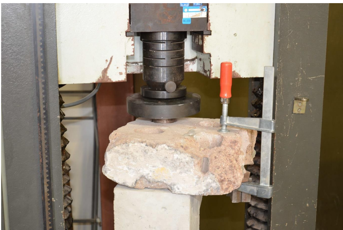
Obr. 62: Průběh zkoušky protlačení spárovací hmoty
