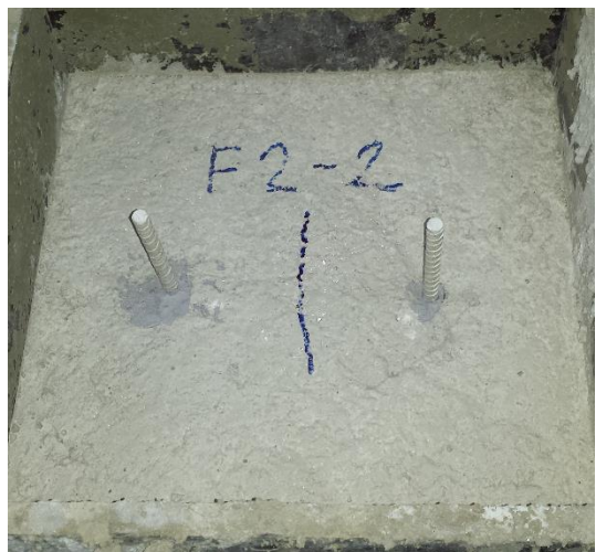
Obr. 8 Zkušební vzorky – 2 trny (betonářská výztuž - GFRP)
