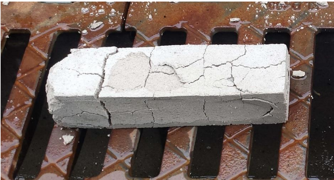
Obr. 71: Zkušební vzorek F7 po požární zkoušce a po aplikaci vody
